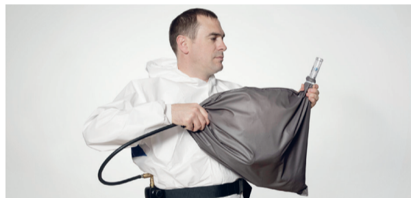
a | Stel het regelventiel in op de laagste stroomregeling met de regelknop en controleer de luchttoevoer (laagste stroomregeling = 120 liter per minuut), zorg voor een goede afdichting rondom het gat in de zak terwijl u de controle uitvoert
