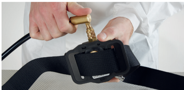
b | Verbind de ademslang met het regelventiel, controleer of de verbinding vast zit door zachtjes aan de slang te trekken
